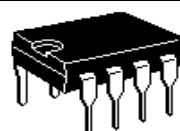
Корпус DIP-8 Типономинал К1460УД2Р
